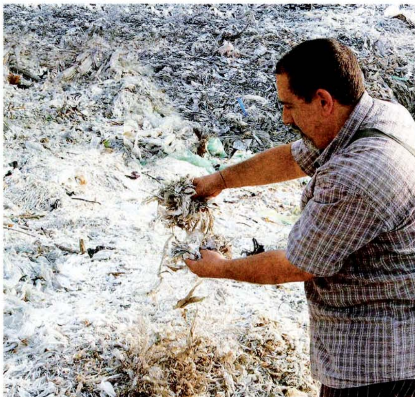
Prima di diventare penne il tetrapak deve essere lavato e lavorato: eccolo qui ridotto in brandelli
